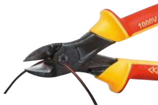
Hard materiaal, zoals pianodraad, dicht bij het scharnierpunt
