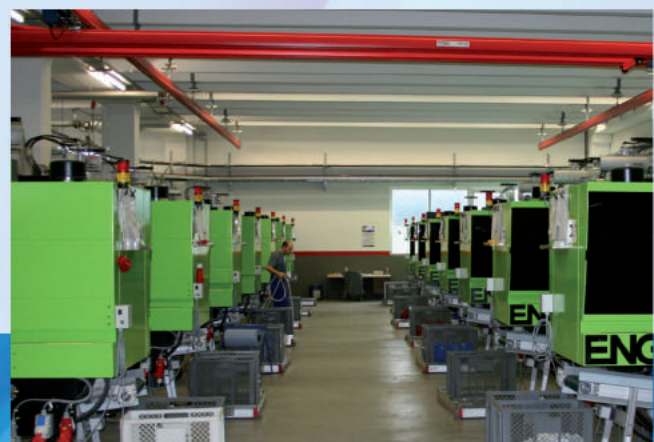
Hoogwaardige spuitgietmachines met centrale granulaatvoorziening in de fabriek te Freiwalde.
